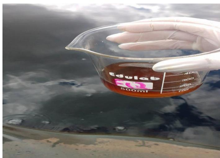
**Figura 10:** Coleta das amostras nas lagoas de captação do Aterro Sanitário Municipal de Dourados-MS, Fonte: SECCATTO, 2017.
