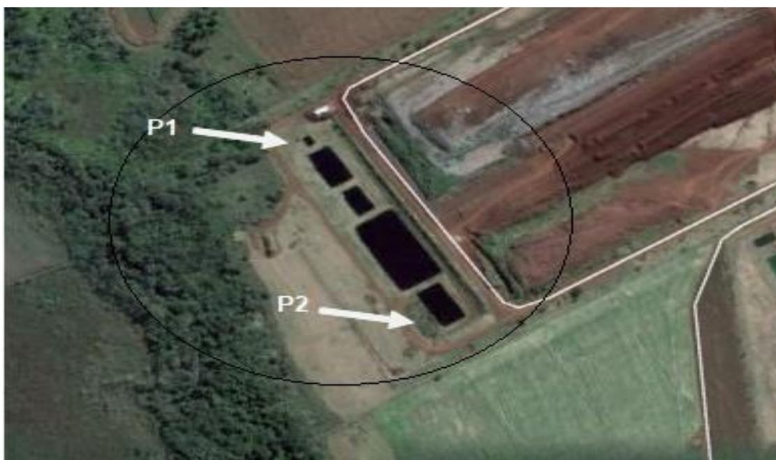
**Figura 9:** Pontos de coletas, **P1** (Lagoa de captação de chorume bruto), **P2** (Lagoa de captação de chorume tratado).
